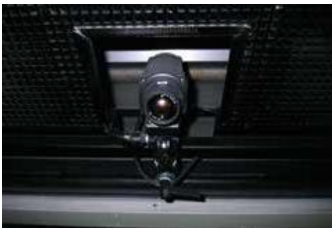
Zentrale Lösung: TOPA installierte in momentan 10 Prüfständen je eine FLIR A310 mit 45°-Weitwinkelobjektiv.
